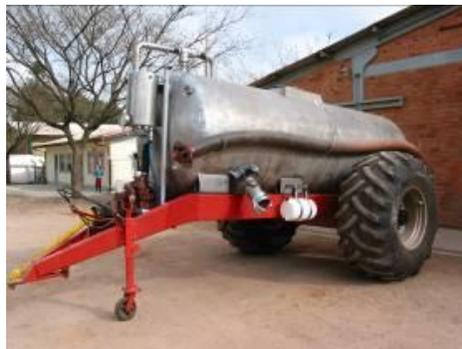
**Figura 19:** Equipo que se utiliza para esparcir el biofertilizante. Obsérvese que el tanque es de acero inoxidable, de plástico no resistiría la presión. La capacidad operativa de este equipo es de 10 ha por día.
